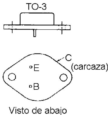
El colector del transistor es la carcasa. Se debe tener la precaución al montarlo en el disipador de que uno de los tornillos quede totalmente aislado del disipador (un niple de cada lado) mientras que el otro debe ir aislado solo del lado del disipador, ya que la cabeza del tornillo debe hacer contacto con la carcasa del transistor. Con una doble tuerca y un terminal para cable se toma la conexión que se ingresa al punto "C" de la placa.
