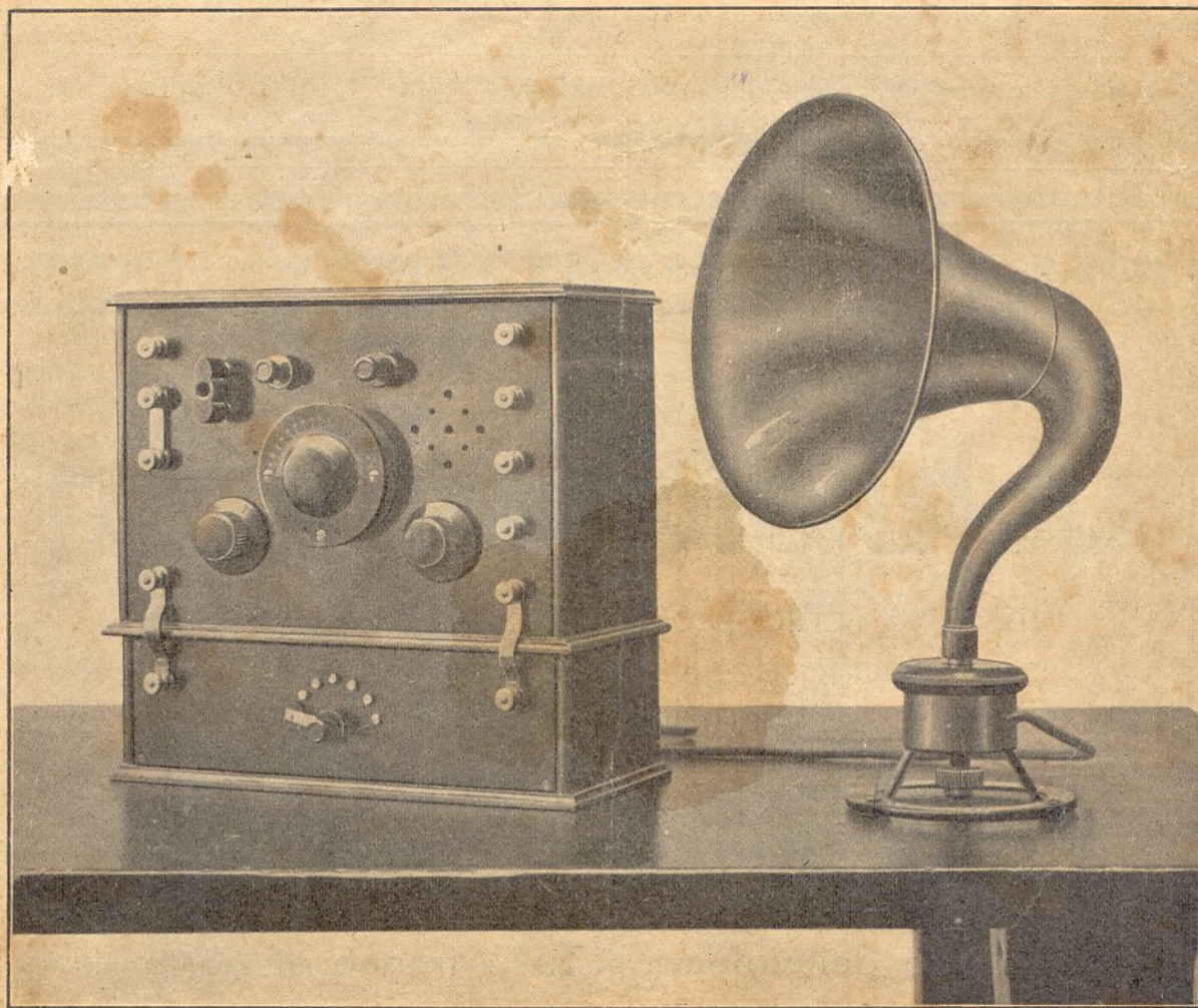
APPARECCHIO SUPERRIGENERATIVO AD UNA VALVOLA
